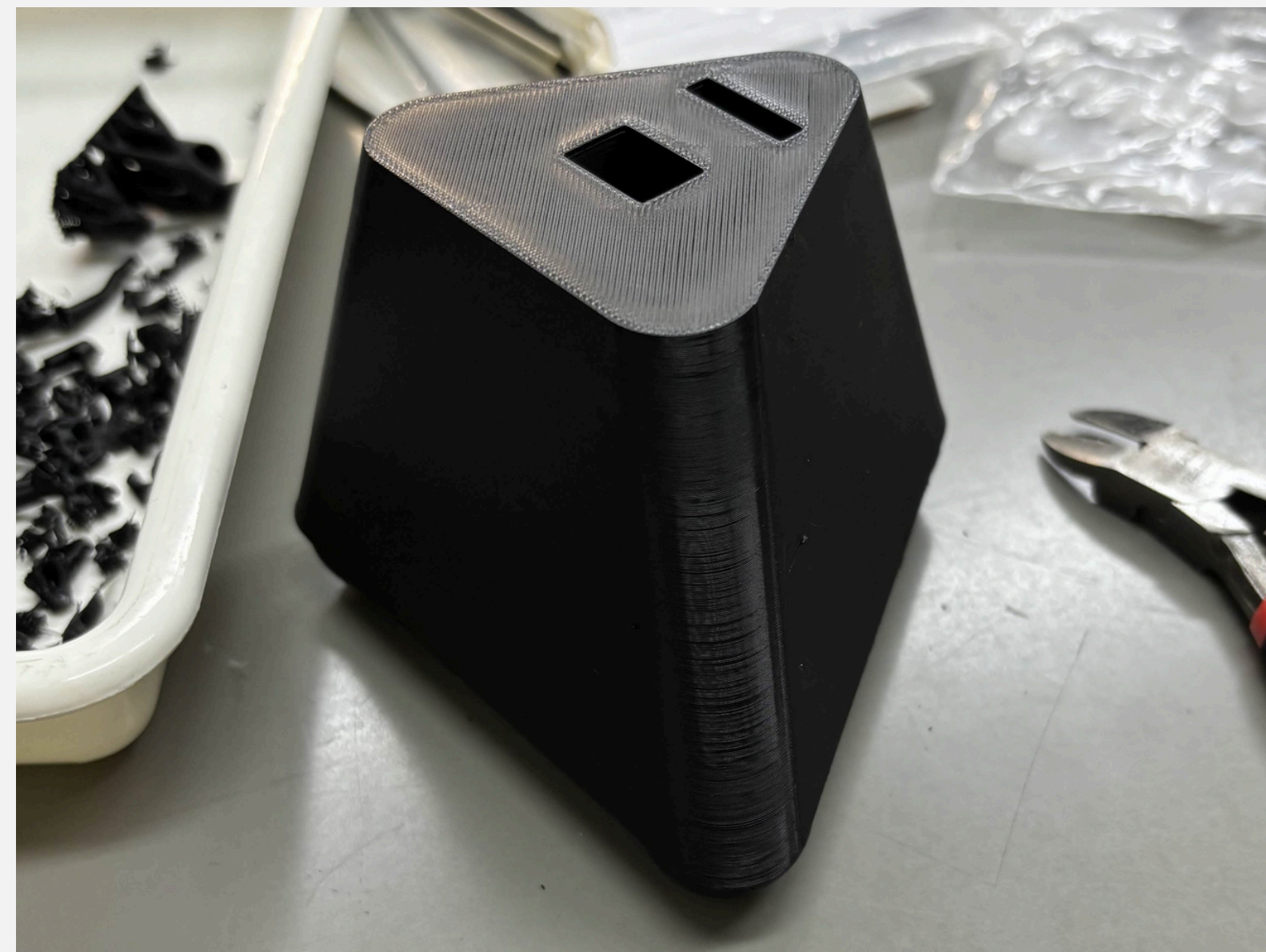
3Dプリンタで製作した收音部土台
